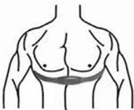
Le capteur dans la ceinture de poitrine transmet directement le rythme cardiaque vers l'ordinateur. La portée maximale du capteur est de 85 cm. Si le capteur est situé à plus de 85 cm de l'ordinateur, le signal sera trop faible pour être capté.
