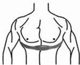
Senzor v hrudním pásu přenáší srdeční tep přímo do počítače. Maximální dosah senzoru je 85 centimetr. Nachází-li se senzor ve větší vzdálenosti od počítače než je 85 centimetr, pak bude signál tak slabý, že jej nebude možno přijímat.
