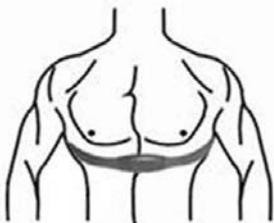
Der Sensor im Brustgurt überträgt die Herzfrequenz direkt an den Computer. Die maximale Reichweite des Sensors beträgt 85 cm. Ist der Sensor mehr als 85 cm vom Computer entfernt, wird das Signal für den Empfang zu schwach sein.
