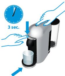
④ Place a container under the coffee outlet. To enter "Emptying the system" mode push the button and the lever down at the same time for 3 seconds. ORANGE steady light indicates entry into the Special functions menu. Placer un récipient sous l'orifice de sortie du café. Pour accéder à la fonction "vider la machine", appuyer sur le bouton et sur le levier en même temps pendant 3 secondes. La lumière ORANGE et fixe indique que vous avez accédé au menu des Fonctions Spéciales.
