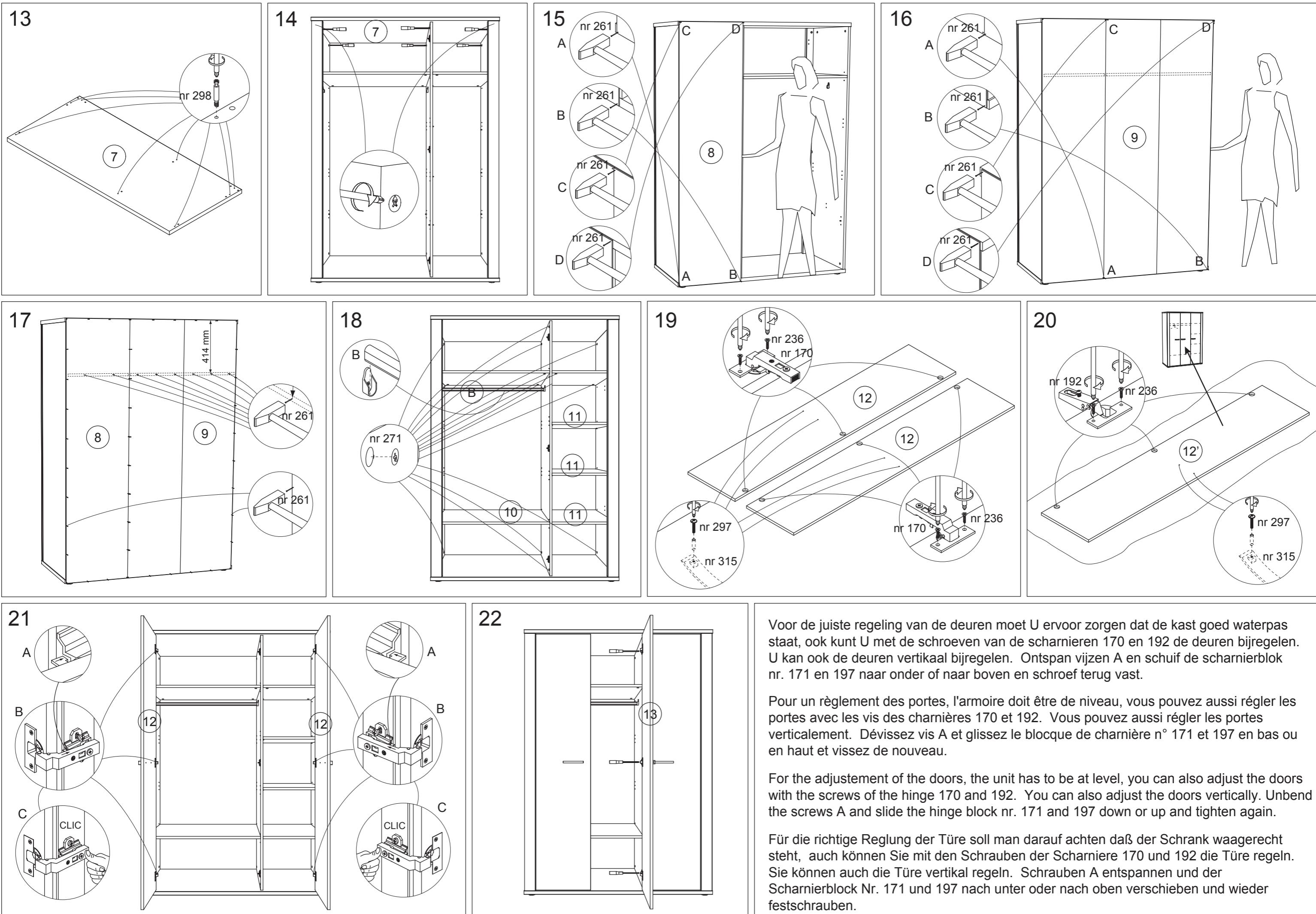
Voor de juiste regeling van de deuren moet U ervoor zorgen dat de kast goed waterpas staat, ook kunt U met de schroeven van de scharnieren 170 en 192 de deuren bijregelen. U kan ook de deuren verticaal bijregelen. Ontspan vijzen A en schuif de scharnierblok nr. 171 en 197 naar onder of naar boven en Schroef terug vast.
