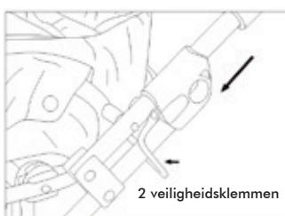
5. Glissez les raccords supérieurs des deux côtés de la poignée vers le bas et fixez-les sur les tubes avant. Veillez à ce que les 2 verrous de sécurité soient bien introduits dans ces tubes.
