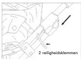
5. Schuif de bovenste koppelstukken aan weerszijden van de duwstang naar beneden en zet ze vast op de voorstangen. Controleer of de 2 veiligheidsklemmen in de voorstangen vastgeschoven zijn.
